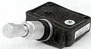
Hellas Sensor mit integriertem Funk-sender ersetzt das Ventil in der Felge.
