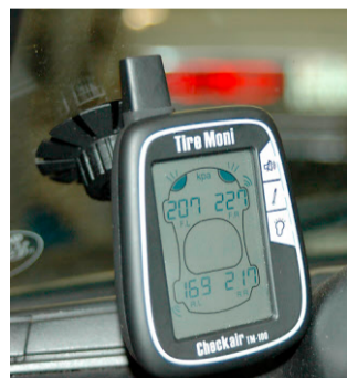
Hier wird Druckverlust («Low Pressure») hinten links signalisiert.
