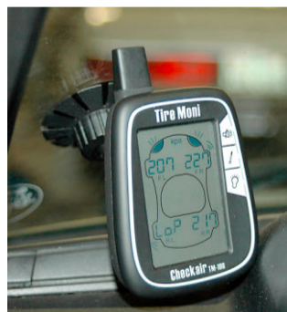
Hier wird Druckverlust («Low Pressure») hinten links signalisiert.
