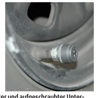
Diebstahlschutz dank Kontermutter und aufgeschraubter Unterlagsscheibe. Macht aber auch das Luftnachfüllen umständlich.
