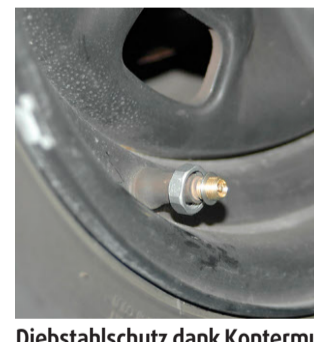
Diebstahlschutz dank Kontermutter und aufgeschraubter Unterlagsscheibe. Macht aber auch das Luftnachfüllen umständlich.
