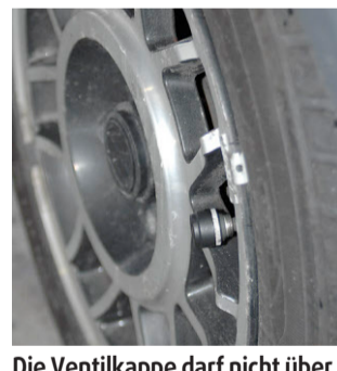
Die Ventilkappe darf nicht über den Felgenreifrand hinausragen.
